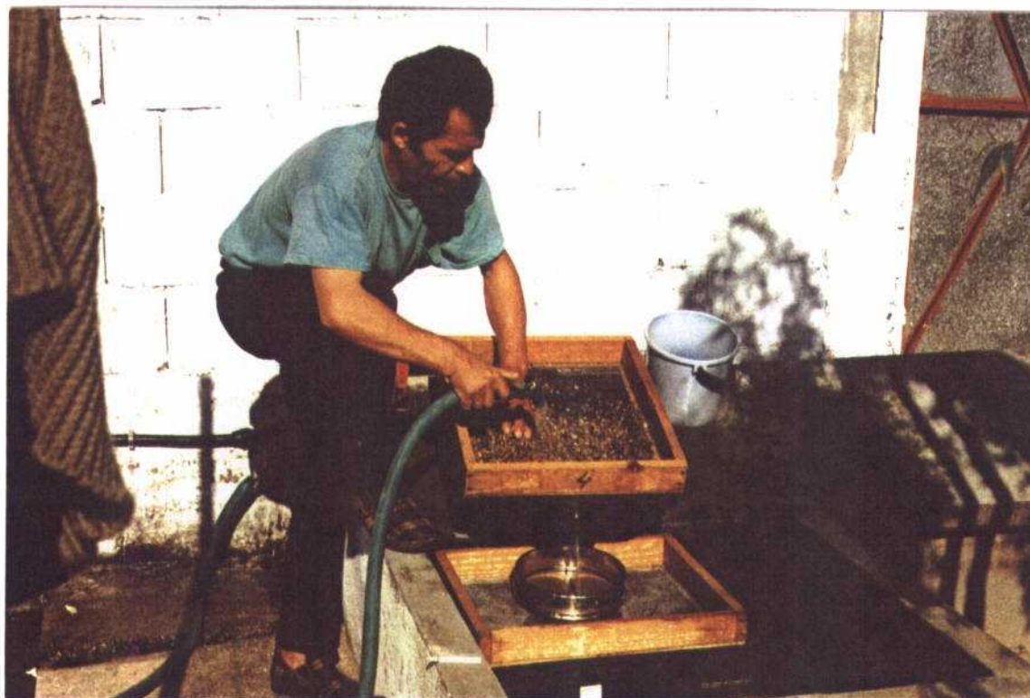
Foto 2: Lavado de las muestras sobre un tamiz de 40 \mu\text{m} .
